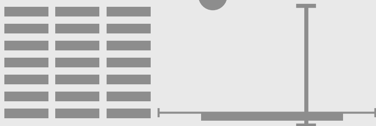
Un transelevador convencional necesita mayor espacio para el amortiguador de seguridad - espacios muertos.
