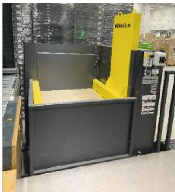
Estación de despaletizado W-DP2-1500
