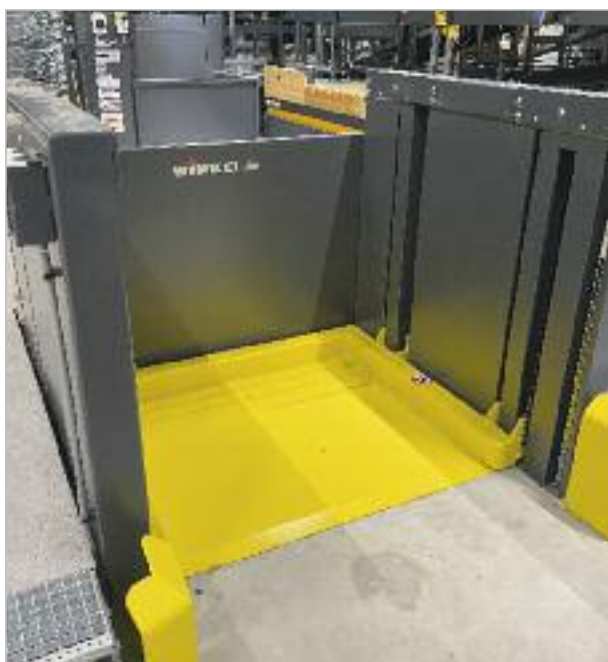
Poste de depalettiseur W-DP2-1500
