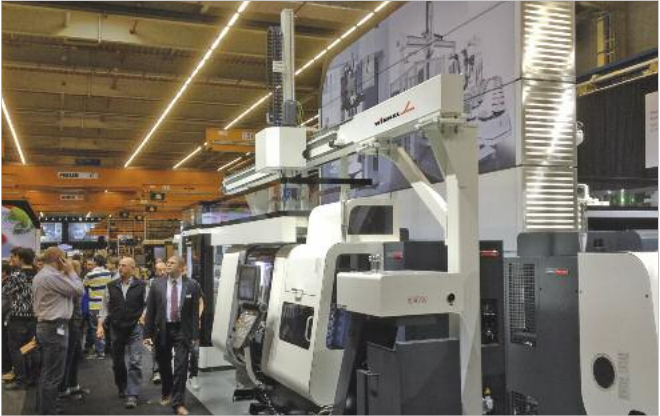
Exemples d'axes linéaires DLE avec axe vertical télescopique
