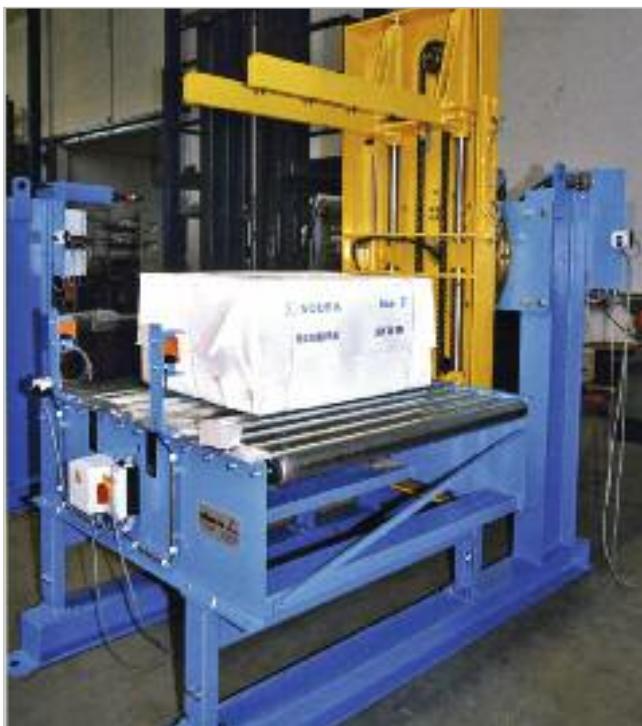
Unità di rotazione per sbavatura particolari in ghisa eseguita da robot
